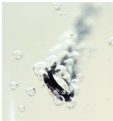
Pedacço de ferro dentro de uma solução ácida. As bolhas dentro do líquido mostram a formação do gás hidrogênio (H 2 ).
